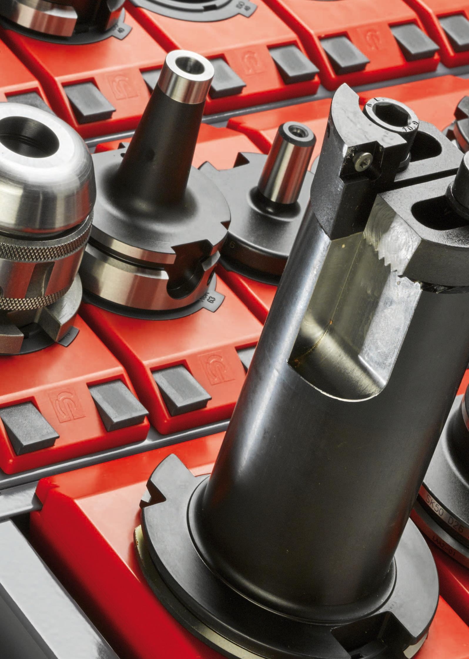
Das originale POLAK NC Aufbewahrungs- und Transportsystem für Werkzeug- und Stanzmaschinen
